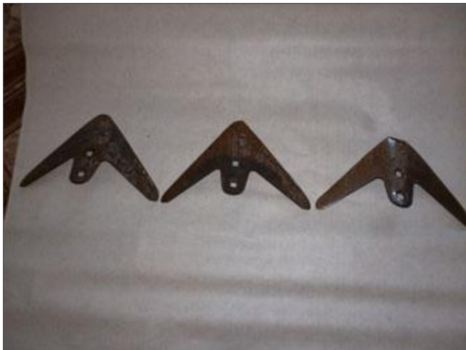
Рисунок 9 – Стрельчатые лапы ООО «Юрий-БС» г. Саратов после наработки 34,7 га на одну лапу
