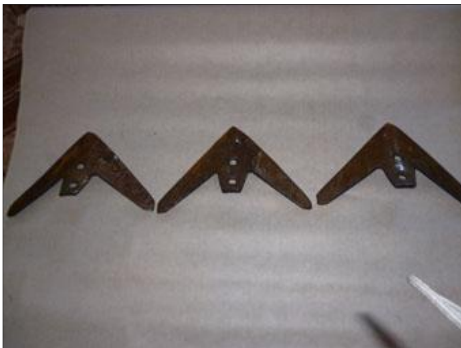
Рисунок 5 – Стрельчатые лапы 043.052.007 наплавленные фирмы «Велес» (Одесса) после наработки 34,7 га на одну лапу
