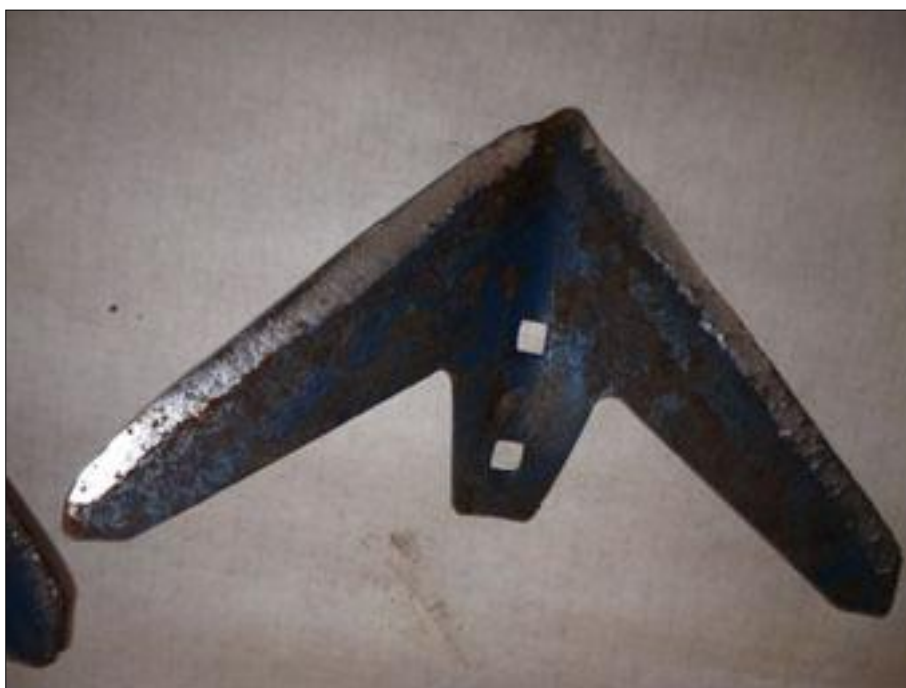
Рисунок 6– Стрельчатая лапа 043.052.007 наплавленная фирмы «Велес» после наработки 34,7 га на одну лапу. Износ лапы со стороны носка
