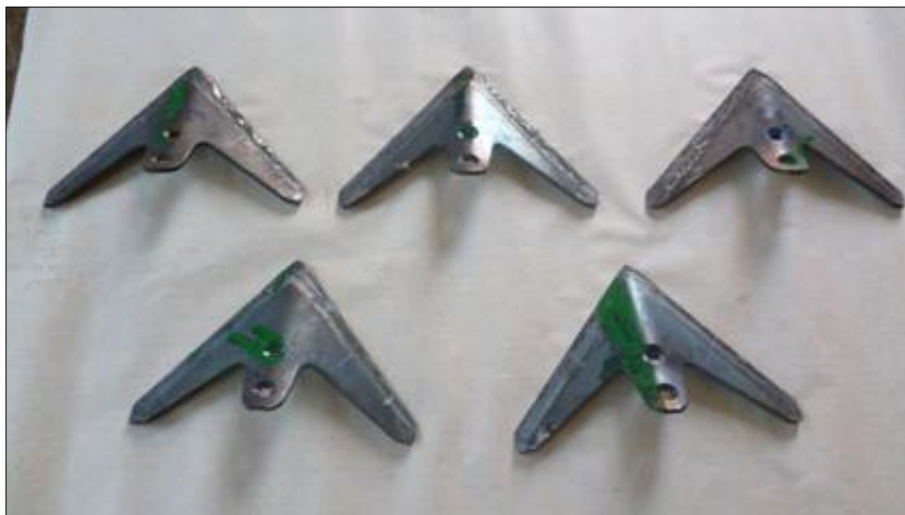
Рисунок 3 – Стрельчатые лапы КПС-4 (изготовитель ООО «Юрий-БС», г. Саратов)
