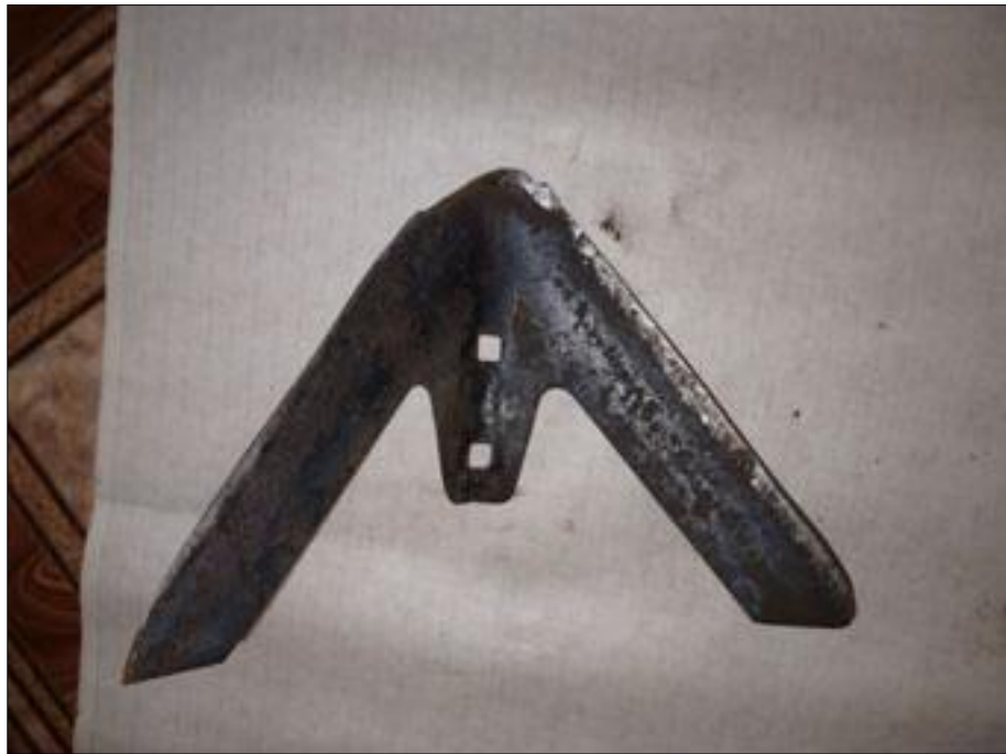
Рисунок 8 – Стрельчатая лапа С5.22 наплавленная Н.043.05.200-07 «СИБАГРОМАШ» после наработки 34,7 га на одну лапу. Износ лапы со стороны носка
