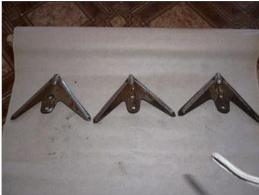
Рисунок 11 – Стрельчатые лапы фирмы ООО «НПП «Валок» после наработки 34,7 га на одну лапу
