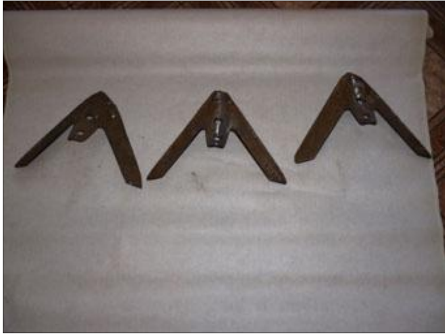
Рисунок 7 – Стрельчатые лапы С5.22 наплавленные Н.043.05.200-07 «СИБАГРОМАШ» после наработки 34,7 га на одну лапу
