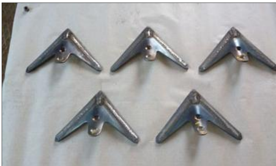
Рисунок 4 – Стрельчатые лапы КПС-4 (полуфабрикат изготовитель ООО «Юрий-БС»), наплавка плазменно-порошковая по технологии ООО «НПП «Валок»
