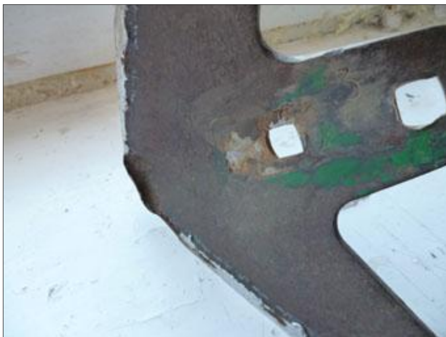
Рисунок 10 – Стрельчатая лапа ООО «Юрий-БС» г. Саратов после наработки 34,7 га на одну лапу. Износ лапы со стороны носка
