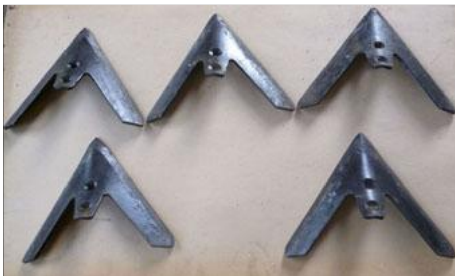
Рисунок 2 – Стрельчатые лапы (КСО, КПС) С5.22 наплавленные Н043.05.200-07 (изготовитель «СИБАГРОМАШ», г. Рубцовск
