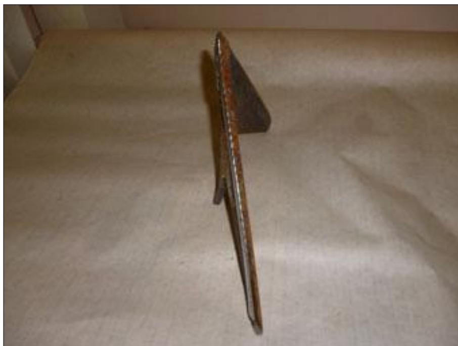
Рисунок 12 – Стрельчатая лапа фирмы ООО «НПП «Валок» после наработки 34,7 га на одну лапу. Самозатачивание режущей кромки лапы (вид сверху)
