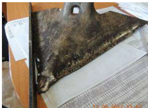
Рис. 8. Лапа типа «агромастер»(375мм), переданная на испытания в фирму АГРОМАСТЕР.
