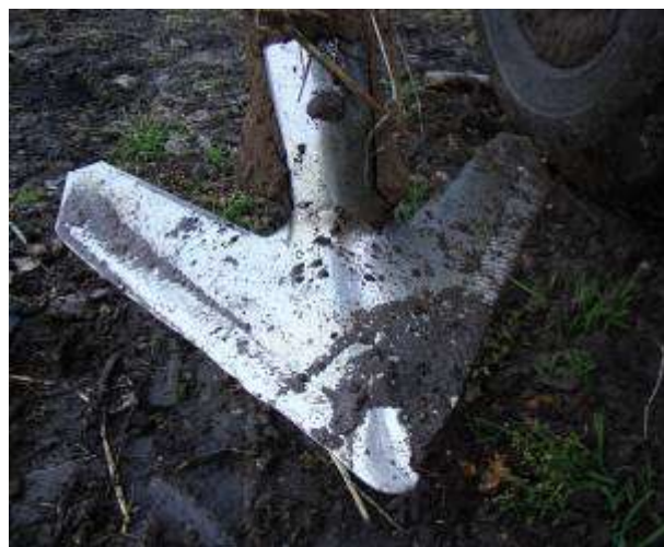
Рис.7. Упрочнённая лапа культиватора BOURGAULT 8810 (60лап) после обработки 1600Га.
