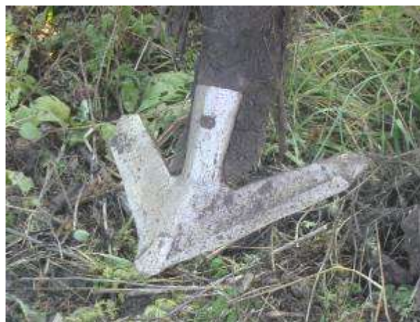
Рис.6. Упрочнённая лапа культиватора BOURGAULT 8810 (60 лап) после обработки 4600 Га.
