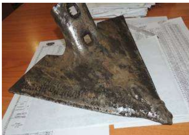
Рис. 8. Лапа типа «агромастер»(375мм), переданная на испытания в фирму АГРОМАСТЕР.
