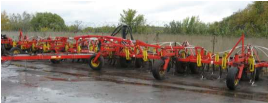
Рис. 4. BOURGAULT 8810, оснащённый лапами, упрочнёнными ООО «НПП ВАЛОК».
