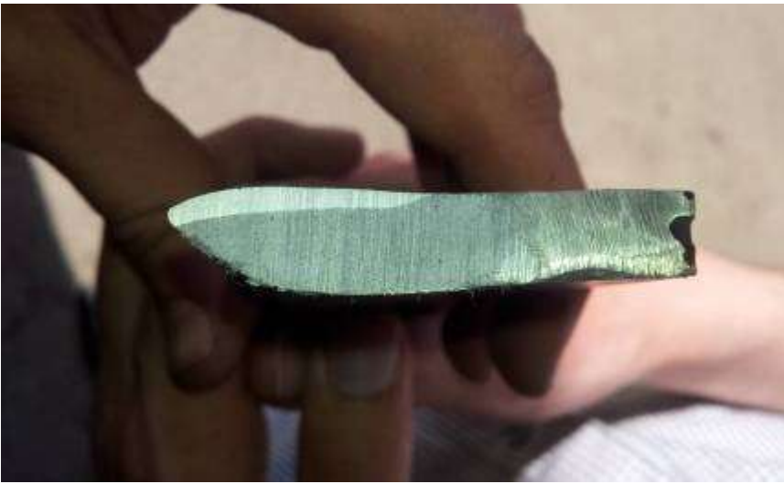
Рис. 3. Разрез крыла лапы «ХОРШ» длиной 330 мм, упрочнённой плазменно-порошковой наплавкой, после наработки 42 Га.
