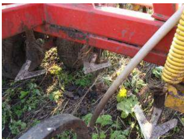
Рис.6. Упрочнённая лапа культиватора BOURGAULT 8810 (60 лап) после обработки 4600 Га.
