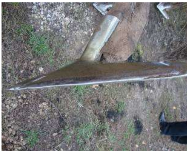
Рис.7. Упрочнённая лапа культиватора BOURGAULT 8810 (60лап) после обработки 1600Га.
