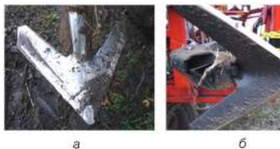
Рис. 5. Вид стрелчатой лапы сверху (а) и снизу (б)
