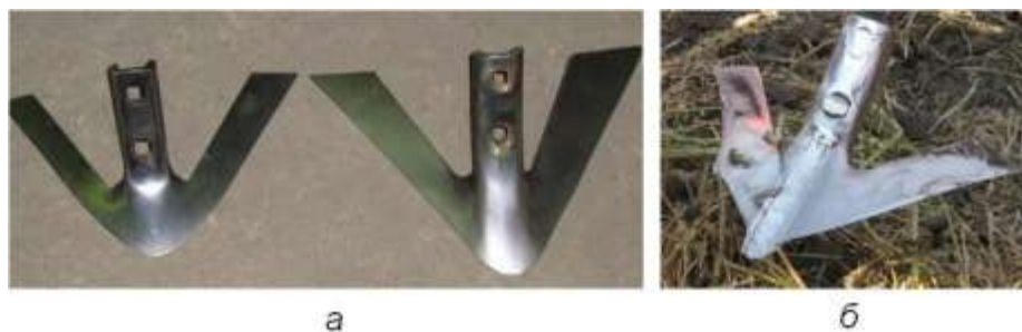
Рис. 6. Лапы «Хорш» после эксплуатации 2012 г): а – типовые лапы, наработка почти 30 га, б – упрочненная наплавкой, наработка более 80 га (эксплуатация за колесом агрегата)
